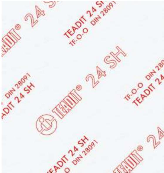
TEADIT® 24 SH ist eine aus gerecktem PTFE hergestellte Dichtungsplatte. Durch ein spezielles Reckverfahren werden flächig in jede Richtung (sowohl längs als auch quer) gleiche Festigkeiten erzielt. Dies hat zur Folge, dass beim Verpressen und Verdichten des Materials ausschließlich eine Veränderung der Dichtungshöhe stattfindet.
