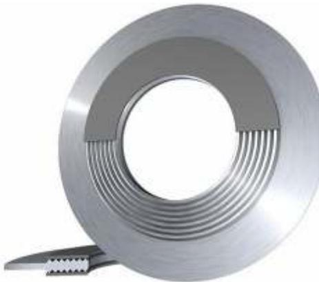
Dieser Dichtungstyp kombiniert die Vorteile von Weichstoffdichtungen (gute Anpassung an die Dichtflächen) mit denen von Metaldichtungen (Ausblässicherheit). Durch die spezielle Dichtungsgeometrie werden die vorhandenen Schraubenkräfte optimal genutzt, gleichzeitig deckt der Weichstoff auch bei hohen Flächenpressungen die Kammspitzen sicher ab.
