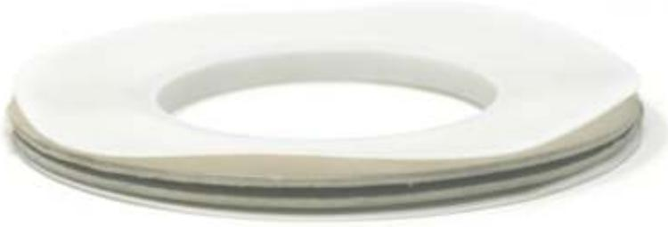
PTFE-Hüllen sind ummantelte Flachdichtungen und werden bei Flanschverbindungen verwendet, die starken chemischen Beanspruchungen ausgesetzt sind. Standardwerkstoff ist PTFE rein, bei höheren Anforderungen an die Druckstandfestigkeit können auch modifizierte PTFE und PTFE-Compounds eingesetzt werden.
