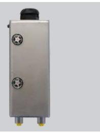
Quenchsysteme HT-QS-T2000 werden zur Versorgung von einfachwirkenden oder Tandem-Gleitringdichtungen eingesetzt. Sie dienen zur Bevorratung der Flüssigkeit am Einsatzort. Der Flüssigkeitsaustausch kann durch Naturumlauf mittels Thermosiphonprinzip oder durch eine Zwangszirkulation mittels Umwälzpumpe oder Fördergewindes erfolgen. Über zwei Schaugläser oder zwei Füllstandsensoren kann der MIN/MAX Füllstand überwacht werden. Am Edelstahlbehälter befindet sich eine Lasche zur Befestigung.
