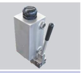
Die Nachspeisepumpe dient zur manuellen Nachspeisung der Sperrflüssigkeit während des Betriebes bei Leckage. Sie wird direkt mit einem Halter an den Behälter montiert.
