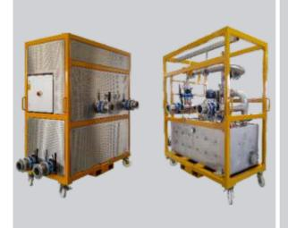
Sperrdruckaggregate übernehmen alle Aufgaben eines Sperrsystems, die zum Betrieb von Doppeldichtungen erforderlich sind: Druckbeaufschlagung, Umwälzung und Kühlung des Sperrmediums sowie den Leckageausgleich.
