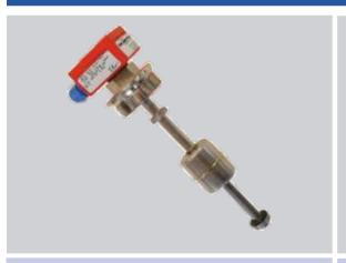
Schwimmerschalter werden zur Grenzstanderfassung von Füllständen eingesetzt. Sie arbeiten unabhängig von Schaumbildung, Druck und Temperatur und sind für nahezu alle flüssigen Medien geeignet. Der Schaltvorgang erfolgt berührungslos und ohne Hilfsenergie. Eine Ausführung nach ATEX ist mögllich.
