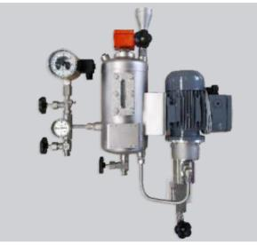
Mit dem Thermosiphonsystem HT-TS-T2000 können Doppel- sowie Tandemgleitringdichtungen in einem breiten Einsatzspektrum versorgt werden. Die Sperrdruckbehälter sind in verschiedenen Größen mit gewölbtem Boden, Schaugläsern zur Füllstandsüberwachung sowie mit oder ohne Kühlschlange lieferbar. An dem Behälter sind serienmäßig alle Prozessanschlüsse und -halterungen vorgesehen. Alle Prozessanschlüsse können als Flansche oder Muffe mit/ohne Dichtfläche ausgeführt werden.
