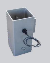
Der Multifunktionsbehälter HT-MFB kann als Qenchbehälter für einfache Anwendungen genutzt werden oder aber auch als Leckageauffangsystem nach Plan 65. Je nach der Belegung der Anschlüsse sind beide Varianten möglich. Zusätzlich kann der Behälter mit Füllstandsensoren ausgestattet werden.
