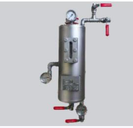
Mit dem Thermosiphonsystem HT-TS-T1000 können Doppel- sowie Tandemgleitringdichtungen in einem breiten Einsatzspektrum versorgt werden. Die Sperrdruckbehälter sind in verschiedenen Größen mit flachem Boden, Schaugläsern zur Füllstandsüberwachung sowie mit oder ohne Kühlschlange lieferbar. An dem Behälter sind serienmäßig alle Prozessanschlüsse und -halterungen vorgesehen. Alle Prozessanschlüsse können als Gewinde mit/ohne Dichtfläche ausgeführt werden.
