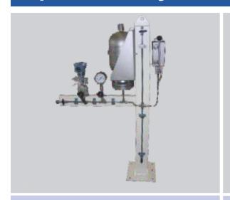
Druckbeaufschlagte Sperrsysteme werden bei abrasiven, umweltschädlichen, giftigen, zur Auskristallisation neigenden Medien, bei hohen Drucken und wenn die Leckagen minimiert werden sollen, verwendet.
