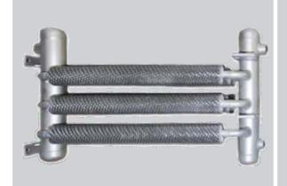
Wärmetauscher der Reihe HT-LWT werden zur Kühlung von Sperrflüssigkeiten in Sperrkreisläufen eingesetzt. Die Wärmetauscher werden aus Rippenrohren hergestellt. Kühlmedium ist die Umgebungsluft. Sie können in einer Spirale oder in einem Rack (wie abgebildet) gefertigt werden.
