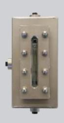
Quenchsysteme HT-QS-T3000 werden zur Versorgung von einfachwirkenden oder Tandem-Gleitringdichtungen eingesetzt. Sie dienen zur Bevorratung der Flüssigkeit am Einsatzort. Der Flüssigkeitsaustausch kann durch Naturumlauf mittels Thermosiphonprinzip oder durch eine Zwangszirkulation mittels Umwälzpumpe oder Fördergewindes erfolgen. Über ein Schauglas kann der MIN/MAX Füllstand überwacht werden. Am Edelstahlbehälter befindet sich eine Lasche zur Befestigung.
