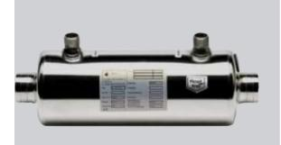
Wärmetauscher der Reihe HT-WT werden zur Kühlung von Sperrflüssigkeiten in Sperrkreisläufen eingesetzt. Die Wärmetauscher werden als Rohrbündelwärmetauscher ausgeführt. Kühlmedium ist ein um die inneren Rohre fließendes Kühlwasser.
