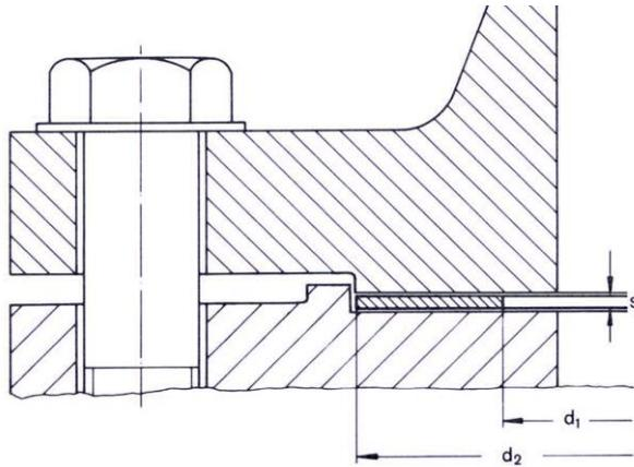
Flachdichtungen nach DIN EN 1514-1, Form SR, für Flansche mit Vor- und Rücksprung, PN 10 bis 100 sowie nach DIN 2692
